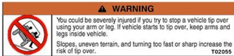
Nebezpečí vážného zranění, pokud se rukou nebo nohou pokusíte zabránit převrácení stroje. Pokud se stroj začíná převracet, držte ruce a nohy zásadně uvnitř vozidla. Nikdy se nepokoušejte zabránit převrácení stroje rukou ani nohou.
